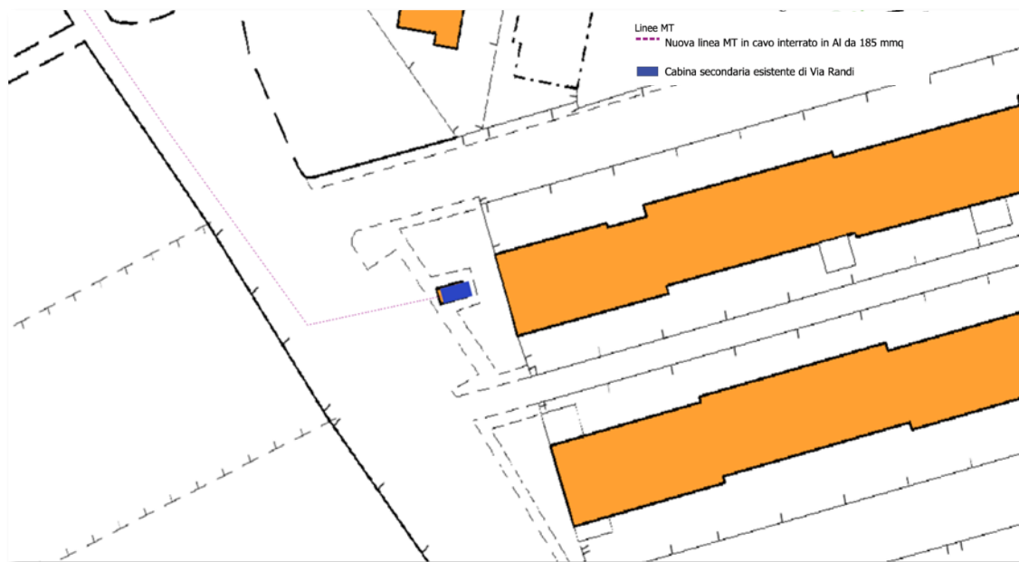
Figura 5-6 - Schema di collegamento linea MT interrata - cabina secondaria via Randi
