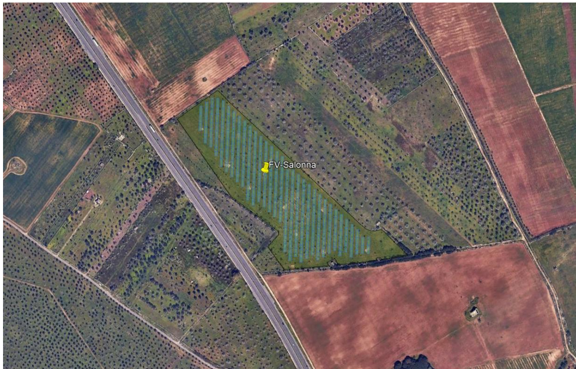
Figura 3-13 - Ortofoto dell'area relativa all'impianto agro-fotovoltaico FV-Salonna, in evidenza l'area recintata e l'ubicazione dei moduli fotovoltaici
